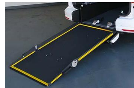
Imagen: Ejemplo de rampa de acceso.
